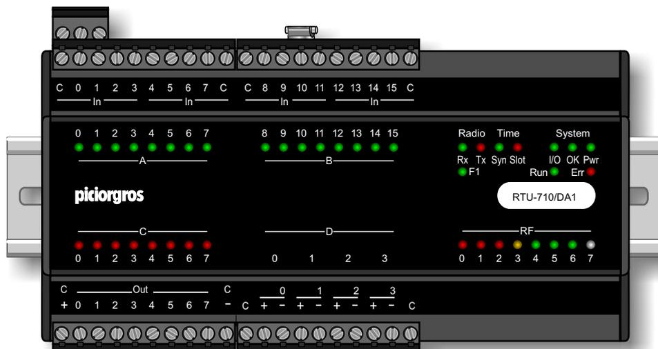
**D**ie RTU-710 (Remote Terminal Unit) Funkbaugruppen haben bereits integrierte binäre und analoge Ein- und binäre Ausgänge sowie integrierte Betriebsstunden- und Ereigniszähler und können optional mit einer PicoLogo Micro-SPS auch einfache Schalt- und Überwachungsaufgaben ausführen. Alle E/A sind galvanisch von der Elektronik getrennt.
