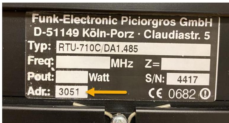
Ab der 810-er-Serie ist dieser Wert dezimal. Daher muss der Wert aus dem alten Format in das neue Format umgerechnet werden. Dies kann mit dem Windows-Rechner oder einem Online-Umrechner wie z.B. [Binär-Dezimal-Hexadezimal Umrechner \(bin-dez-hex-umrechner.de\)](http://bin-dez-hex-umrechner.de) geschehen.
